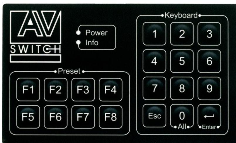
Функциональная группа «Keyboard» позволяет коммутировать любой вход на соответствующий выход. Для этого необходимо набрать номер входа, затем «Enter», затем номер выхода и снова «Enter».
