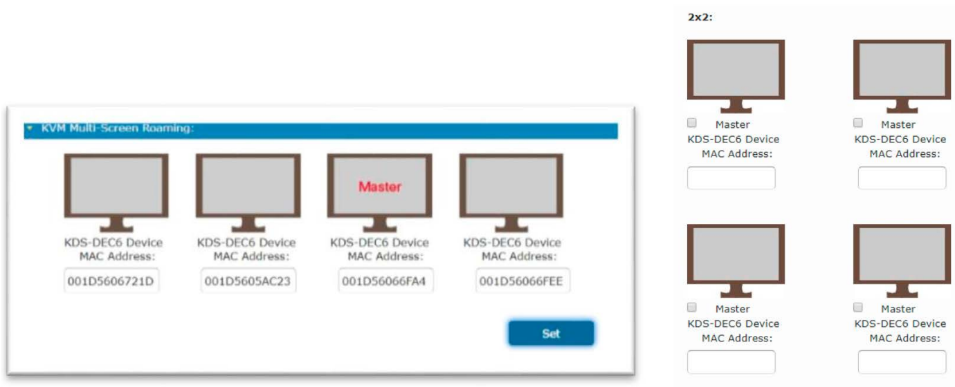
Рис. 14. Страница мастер-устройства декодера — варианты конфигурации 1x4 и 2x2
