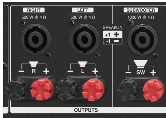
Fig. 3. Conexiones de salida para altavoces en el panel posterior
